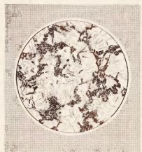
Рис. 56. Шарообразный чугун под микроскопом
