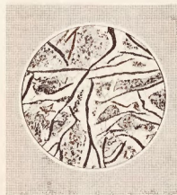
Рис. 55. Серый чугун под микроскопом
