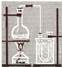
Рис. 65. Прибор для получения нитрата аммония
