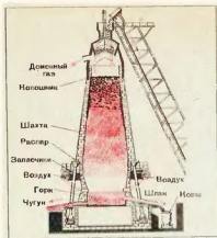
Рис. 58. Доменная печь (схема)
