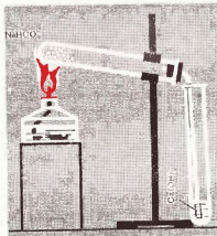
Рис. 66. Прибор для разложения гидрокарбоната натрия
